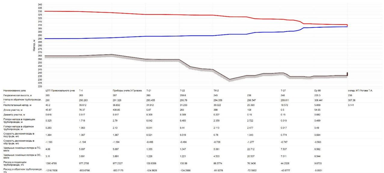
Рисунок 1.3.8.8 - Пьезометрический график от ЦТП до склада
