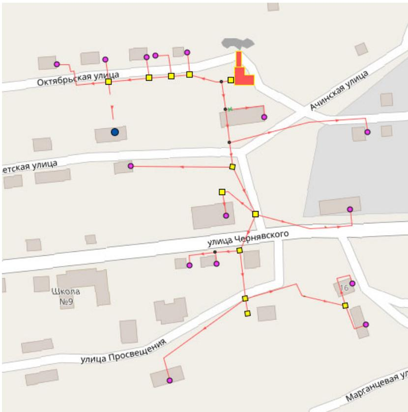
Рисунок 1.3.2.4 - Схема тепловой сети котельной №3
