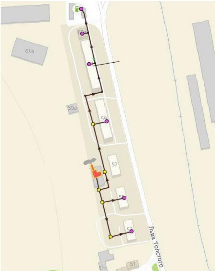
Рисунок 1.3.2.2 - Схема тепловой сети котельной №1
