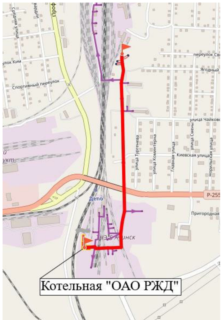
Рисунок 4.2.27. Путь построения пьезометрического графика котельной ОАО «РЖД»
