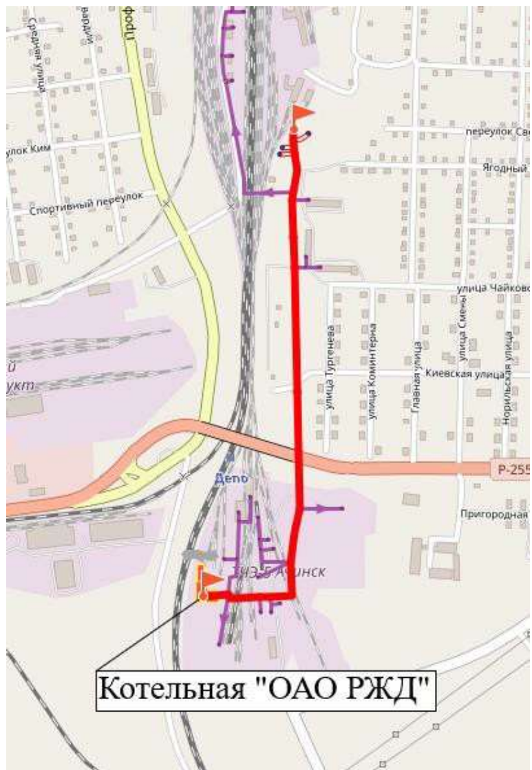
Рисунок 4.2.27. Путь построения пьезометрического графика котельной ОАО «РЖД»
