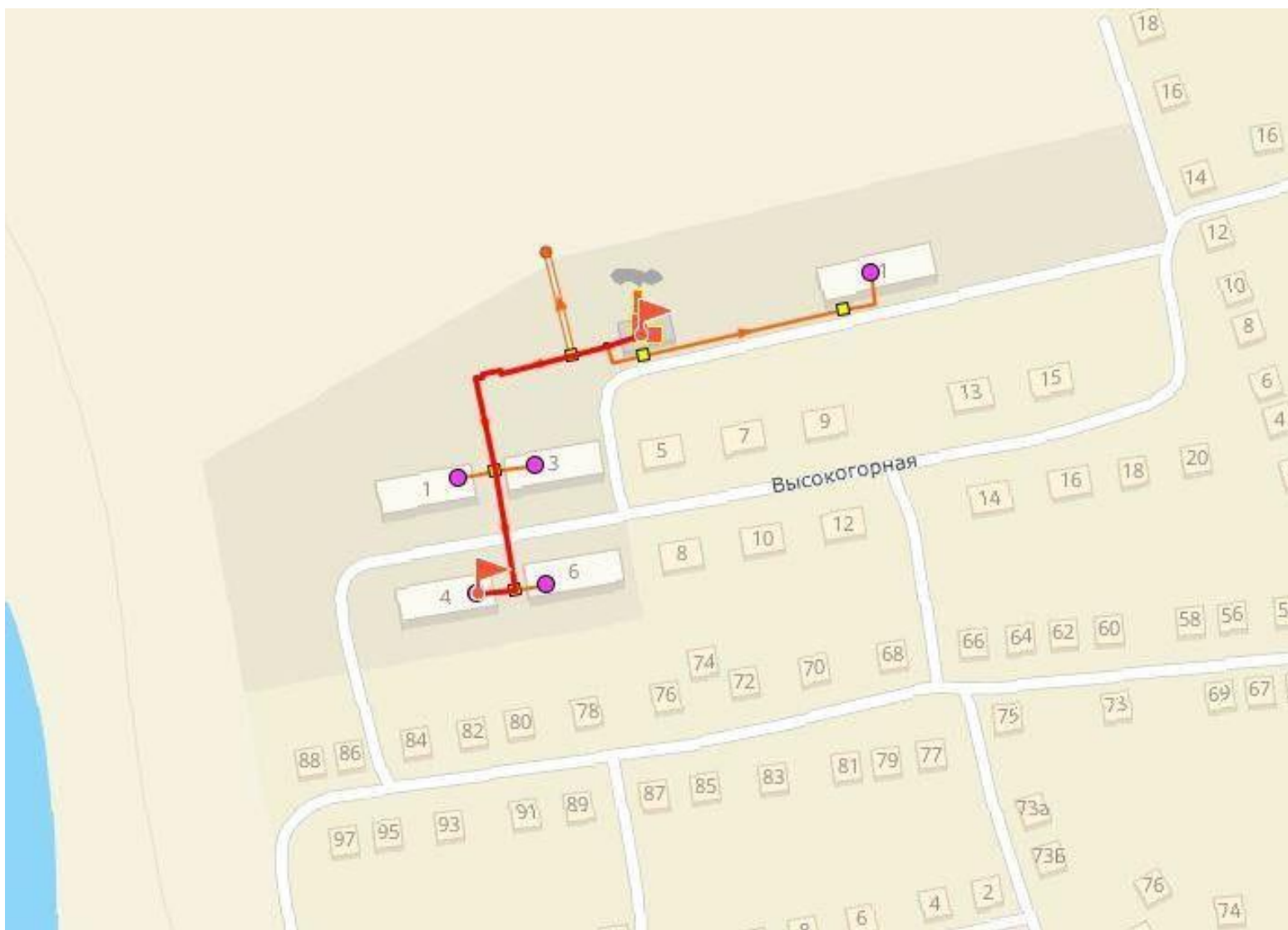
Рисунок 4.2.15. Путь построения пьезометрического графика котельная №2 – ж/д №6
