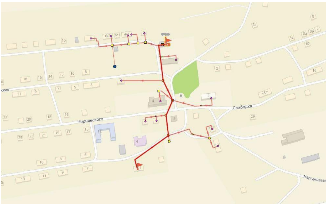
Рисунок 1.3.8.13 - Путь пьезометрического графика от Котельной №3
