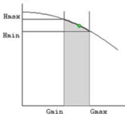
Рисунок 3.2.16. Напорно-расходная характеристика насоса
