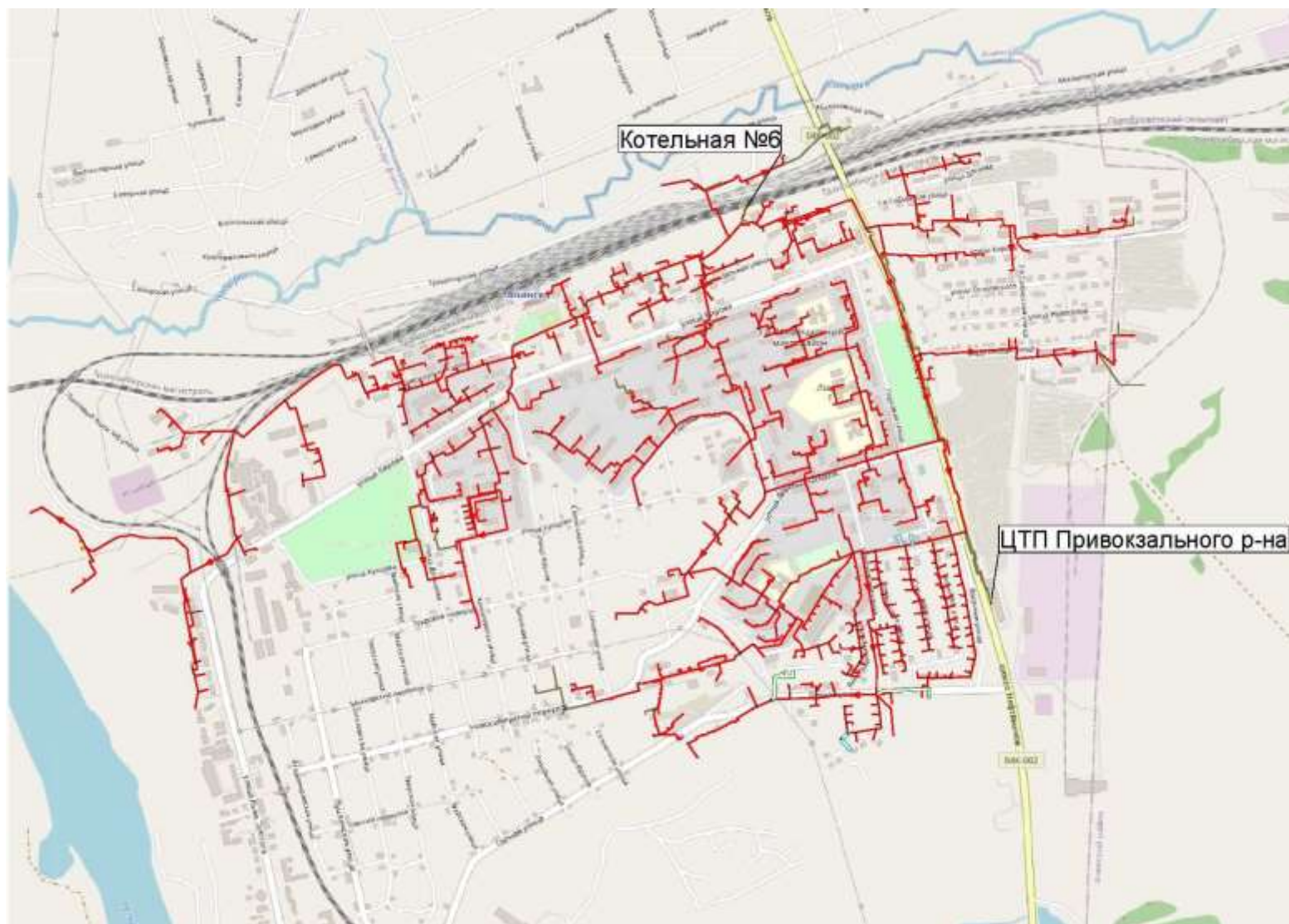
Рисунок 4.2.4. Перспективная схема сетей котельной №6 ООО «Теплосеть»
