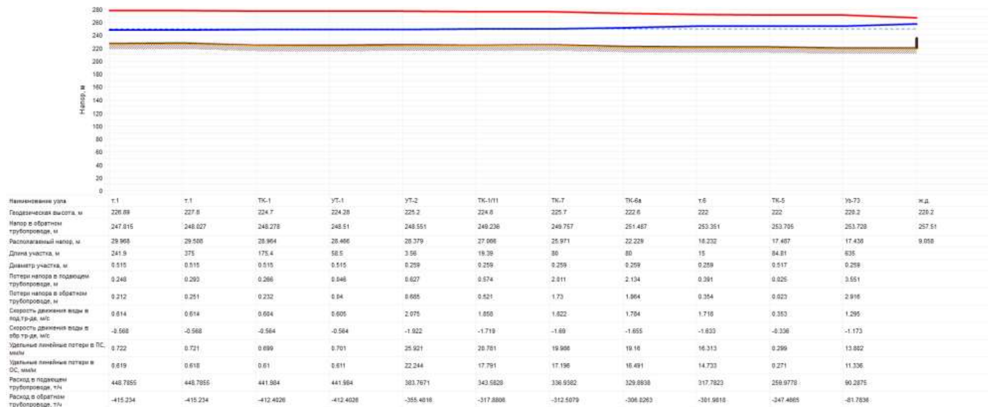
Рисунок 4.2.26. Пьезометрический график котельная ООО «ТК Восток» – ЮВР,66
