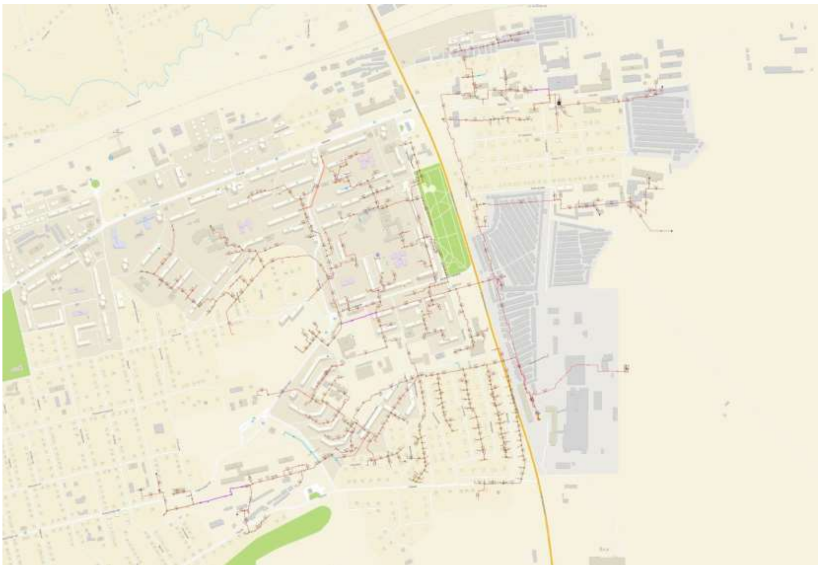
Рисунок 4.2.2. Перспективная схема сетей от ЦТП ООО «Теплосеть»
