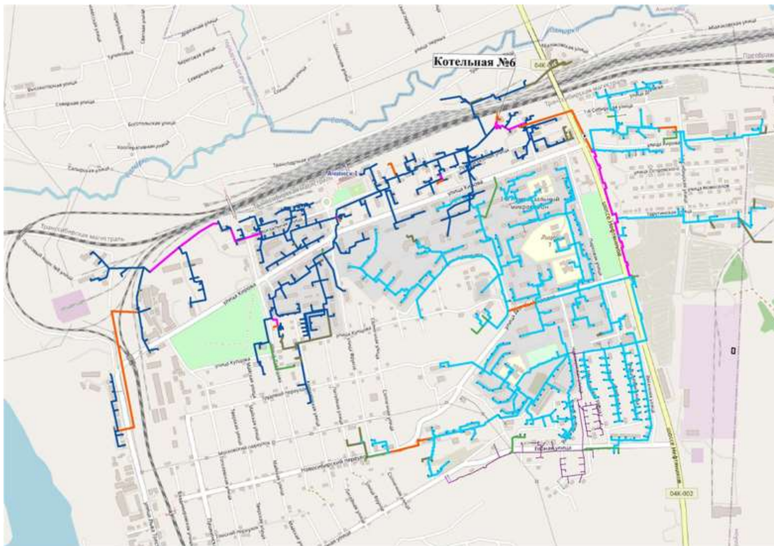
Рисунок 5.1.1. Схема сетей теплоснабжения после переключения части потребителей от ТЭЦ АО «РУСАЛ Ачинск» к котельной №6 ООО «Теплосеть»
