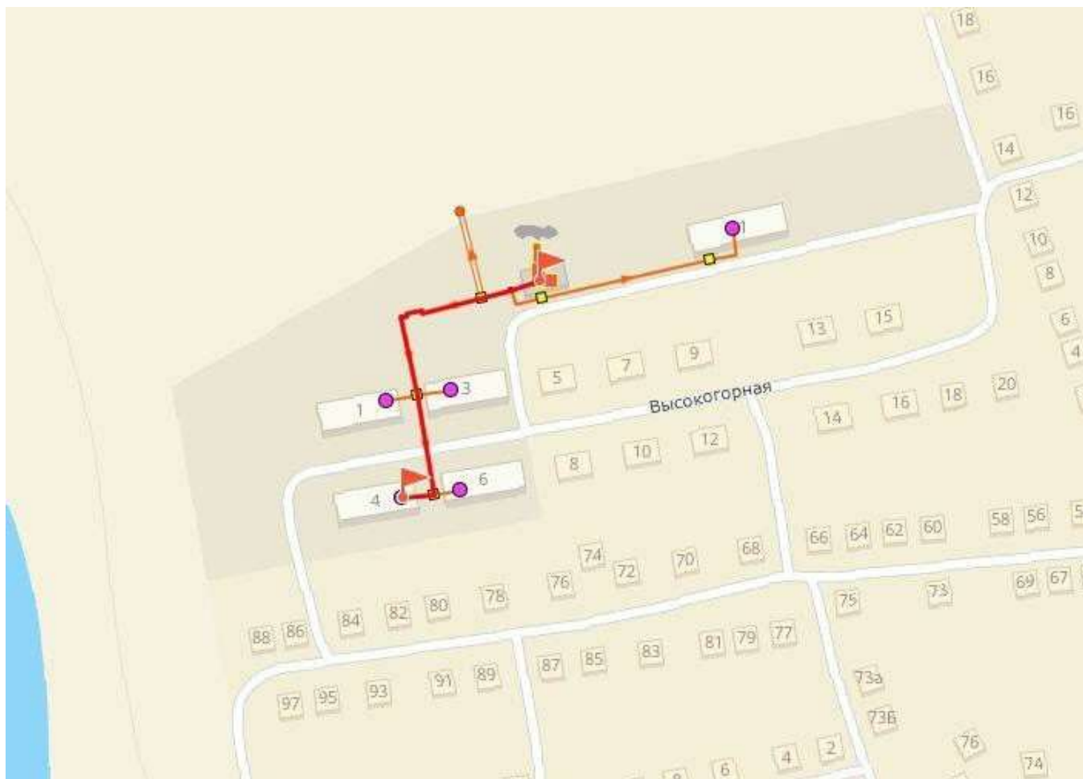
Рисунок 4.2.15. Путь построения пьезометрического графика котельная №2 – ж/д №6
