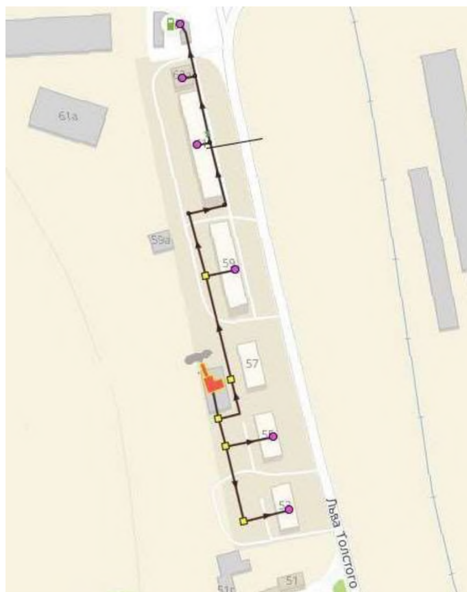
Рисунок 1.3.2.2 - Схема тепловой сети котельной №1
