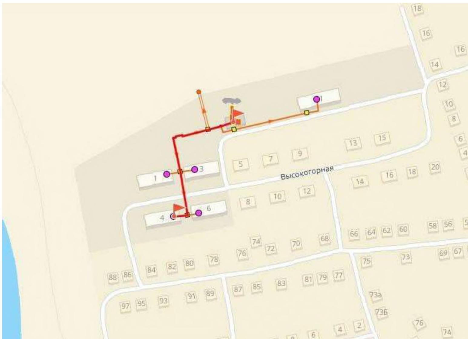
Рисунок 4.2.15. Путь построения пьезометрического графика котельная №2 – ж/д №6
